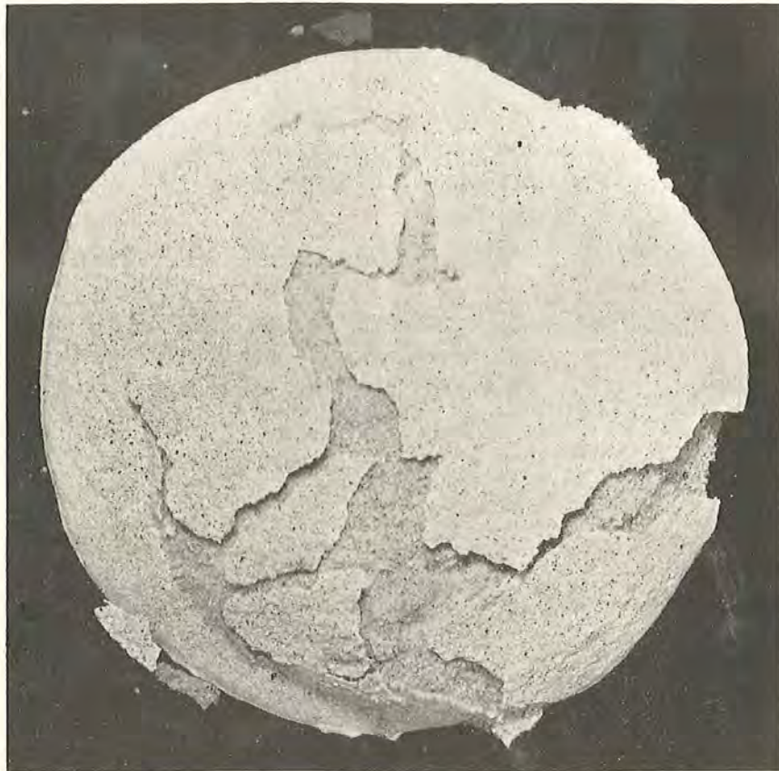
Fig. 14. Karbonatskorpens Sprængning paa 3 Døgn gammel luftlagret Kalkmørtel med P_k : P_s = 1 : 9,42 ved Nedlægning i Vand. Sand Storrelse.
